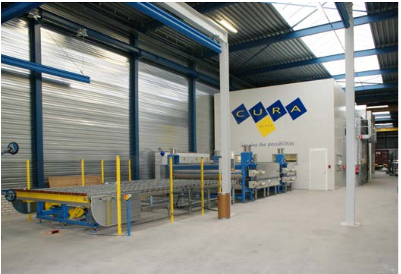
Nuestra línea de laminación para la producción de CURA Safe
