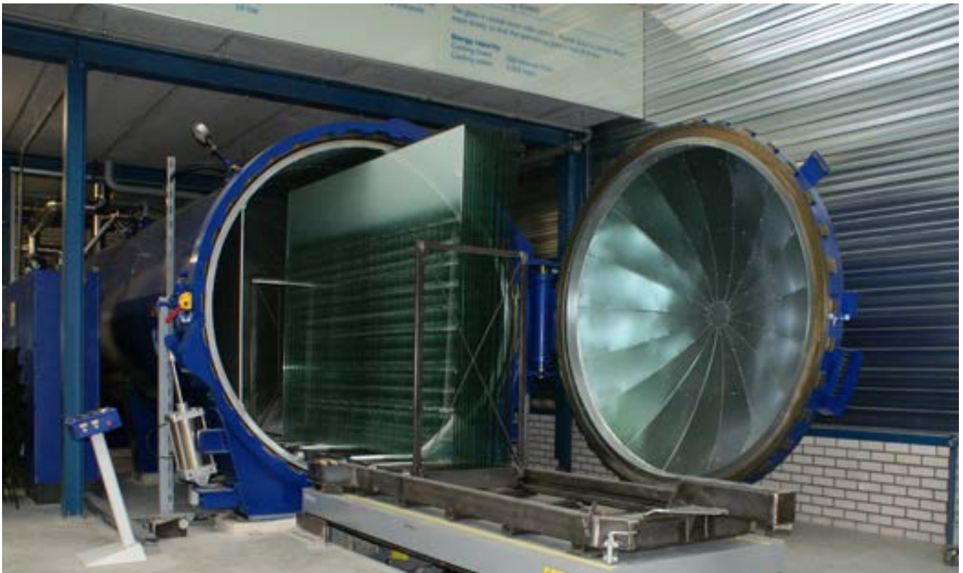
El autoclave es parte de nuestro proceso de producción de vidrio laminado CURA Safe con capa intermedia de PVB
