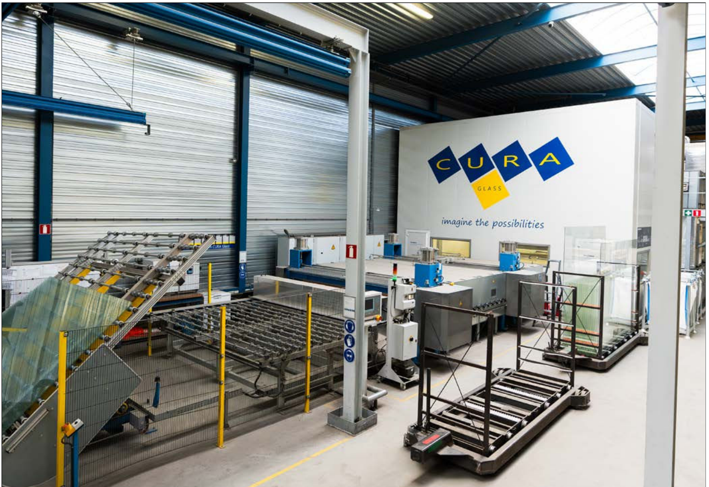
Unsere Laminier Anlage für Produktion der CURA Safe
