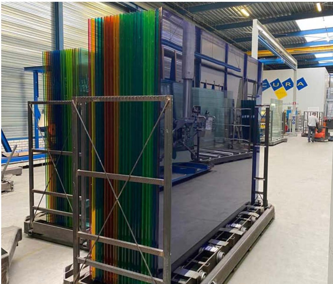
CURA Safe gelaagd glas met Blank Float en gekleurde Vanceva PVB-folie
