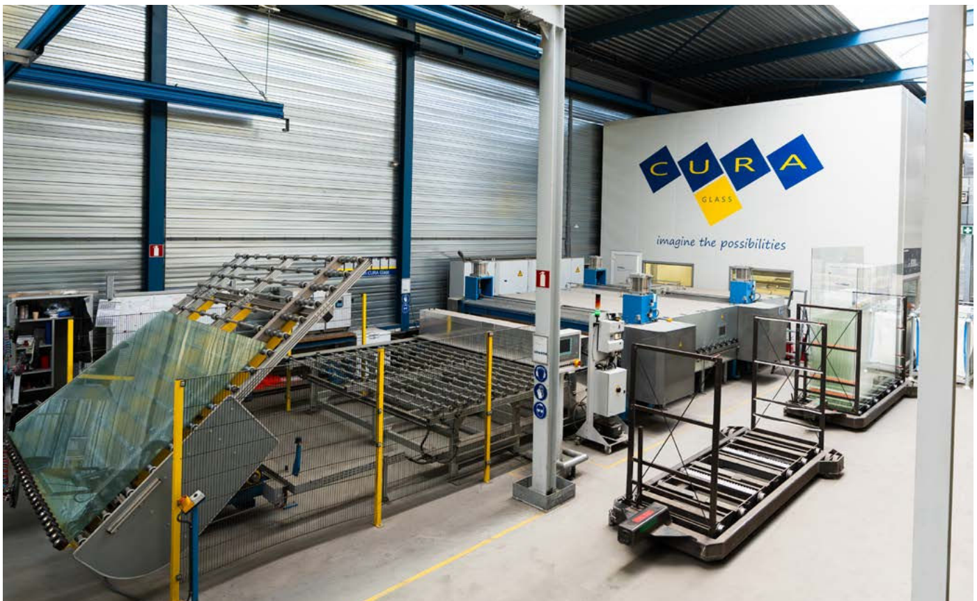
Onze Benteler-lamineerlijn voor de productie van CURA Safe met PVB-folie
