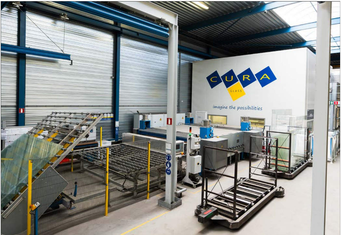
Unsere Laminier Anlage für Produktion der CURA Safe
